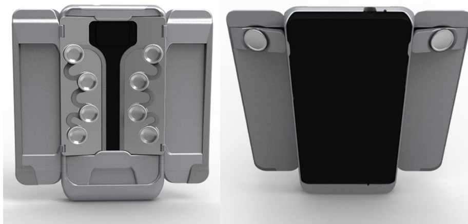
Рис. 3. Клавиатура Октодон. Вид сзади (слева) и спереди (справа) в разложенном состоянии, предназначенном для ввода текста
