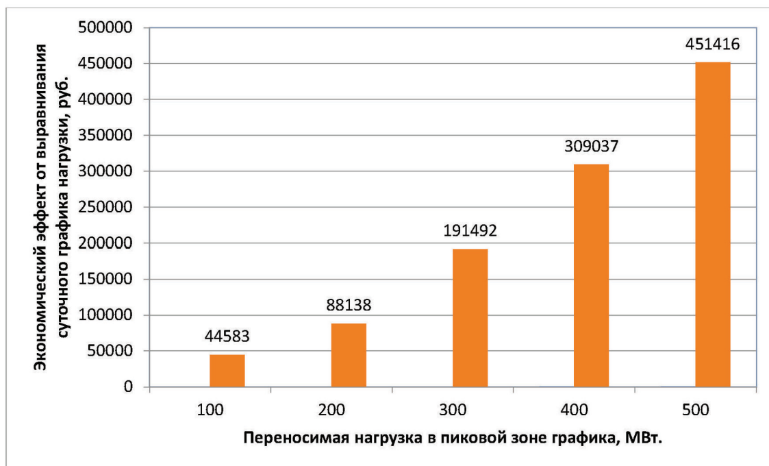
Рис. 5. Зависимость экономии на закупках электроэнергии от переносимой нагрузки (рассчитано авторами на основе данных, представленных на рис. 3 и 4)
